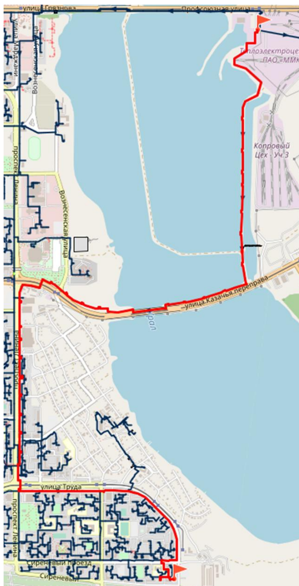
Рисунок 19 Путь движения теплоносителя от ТЭЦ 1000 до здания скорой помощи (70)
