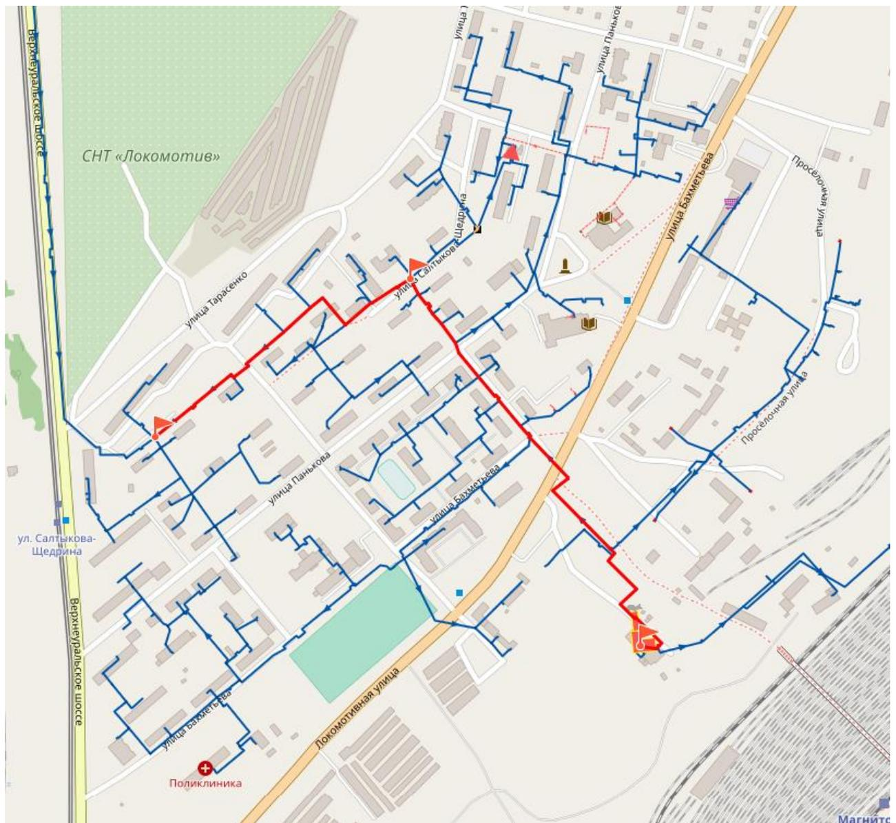
Рисунок 22. Расчетный путь по направлению от котельной пос. Железнодорожников до УТ-14.7
