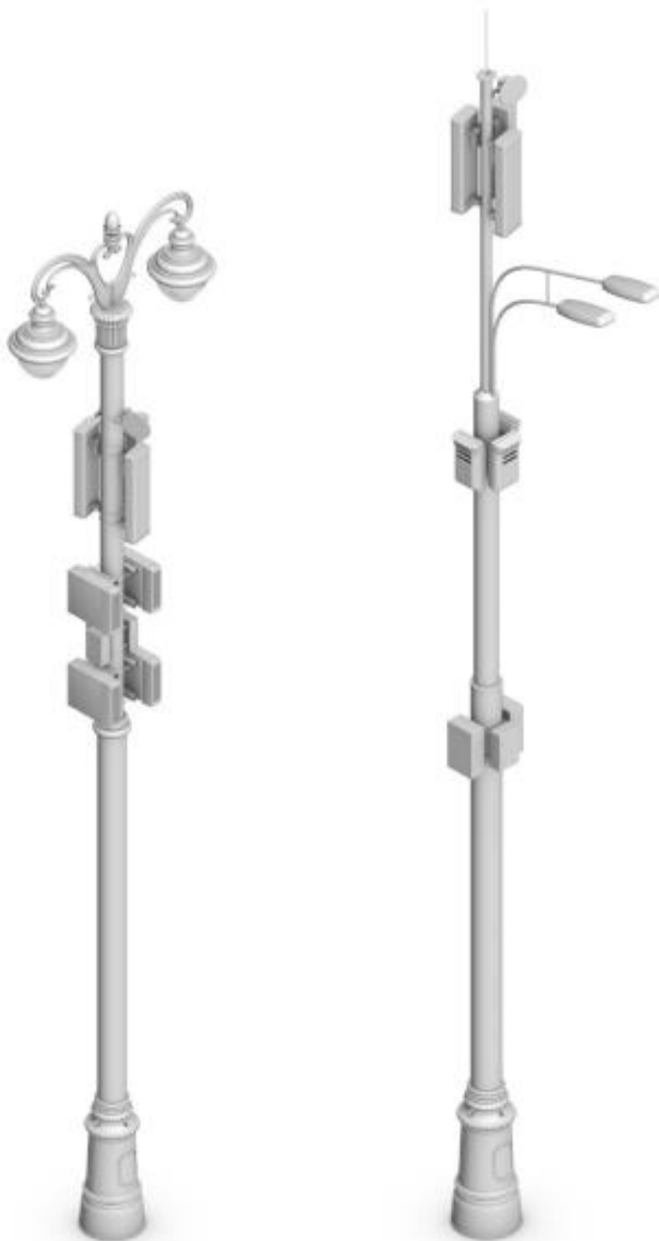
Размещение компактного оборудования на ОДН в видовых местах и на территориях, представляющих историческую ценность
